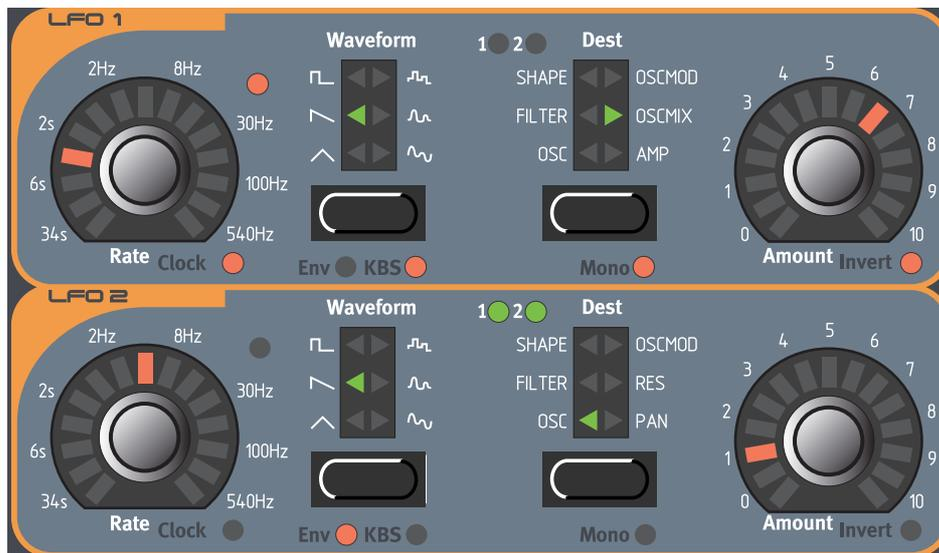
LFO significa “low frequency oscillator” (“oscilador de baja frecuencia”). Un LFO es un oscilador que produce formas de onda tal y como lo haría un oscilador normal, pero con unas cuantas diferencias:
