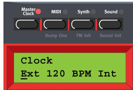
Aquí eliges entre sincronía con el Reloj Interno y Externo. Selecciónalo girando el **DIAL GIRATORIO**. Presiona el botón de navegación **DERECHA** y ajusta el tempo (en BPMs) con el **DIAL GIRATORIO**.
