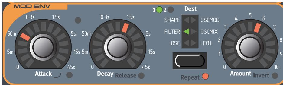
La Envolvente de Modulación es un tipo sencillo de envolvente que sólo tiene controles para el Ataque, el Decay / Release y la Cantidad. Envía una señal de control que puede tener el siguiente aspecto:
