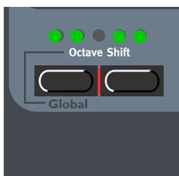
En el modo Cambio de Octava Global, los botones **OCTAVE SHIFT** afectan a todos los Programas en las Partes seleccionadas. Las notas enviadas por el **MIDI OUT** también cambian de octava. Esto significa que en el modo Cambio de Octava Global, el Nord Lead 3 sólo puede enviar Notas MIDI en un rango de 8 octavas, de Do0 a Do8 (C0-C8). Para entrar en el modo Cambio de Octava Global,
