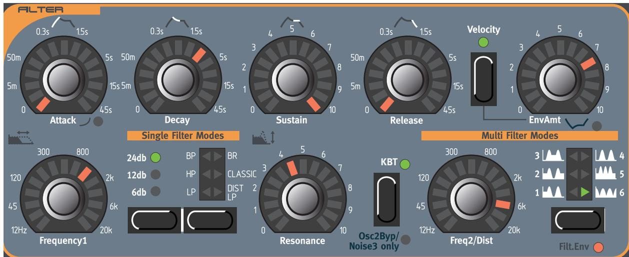
El Filtro es uno de los más importantes componentes para modelar el timbre general del sonido. Nord Lead 3 presenta dos filtros multi-modo. Puedes utilizar un único filtro (Modos de Filtro Individual) o ambos (Modos Multi-Filtro). El Filtro puede ser controlado desde el generador de Envolvente del Filtro dedicado.
