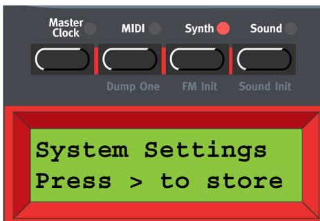
Aquí almacenas los valores de todos los parámetros del menú Sintetizador, así como una serie de otros parámetros incluyendo qué Programas deben cargarse en cada Parte, qué parte debe estar activada / desactivada, los parámetros MIDI, la configuración del Reloj Maestro, etc. Presiona el botón de navegación **DERECHA** para almacenar la Configuración del Sistema en la memoria Flash interna del Nord Lead 3.
