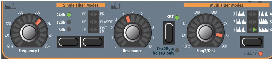
Si giras **FREQUENCY1**, el Display mostrará el valor de Frecuencia1 y su relación con Frecuencia2. En este ejemplo Frecuencia1 es 1/6.349 de Frecuencia2
