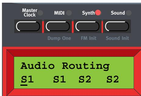
Aquí configuras el Encaminamiento del Audio para las Partes A-D, es decir, como las cuatro Partes van a encaminar su sonido hacia las salidas físicas del Nord Lead 3 (consulta “[Conexiones](#)” en la [página 11](#)). Selecciona una Parte con los botones de navegación **DERECHA / IZQUIERDA**, o presionando el botón de **PARTE** correspondiente. Cambia el Encaminamiento del Audio con el **DIAL GIRATORIO**.
