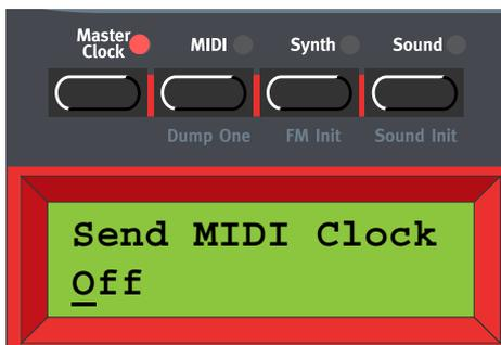
Aquí puedes activar / desactivar la transmisión de datos de Reloj MIDI. Selecciona entre Encendido (“On”) y Apagado (“Off”) girando el **DIAL GIRATORIO**. Cuando activas la transmisión de Reloj MIDI, un mensaje de Comienzo del Reloj MIDI también será transmitido. Cuando desactivas la transmisión de Reloj MIDI, un mensaje de Detención del Reloj MIDI también será transmitido.
