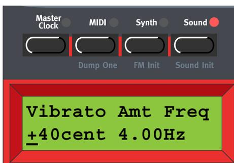
Aquí configuras la cantidad de modulación y frecuencia del Vibrato. Configura la cantidad de Vibrato girando el **DIAL GIRATORIO**.
