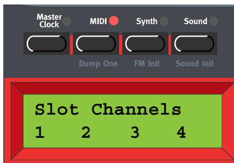
Aquí seleccionas el canal MIDI para cada una de las cuatro Partes del Nord Lead 3. Selecciona la Parte con el botón de navegación **IZQUIERDA / DERECHA** o presionando el botón de la **PARTE** correspondiente. Selecciona el canal MIDI para la parte seleccionada con el **DIAL GIRATORIO**.
