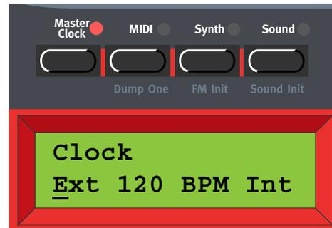
En el primer menú, selecciona entre sincronía con el Reloj Interno (Int) o Externo (Ext). Selecciónalo girando el **DIAL GIRATORIO**. Presiona el botón de navegación **DERECHA** y ajusta el tempo (en BPMs) con el **DIAL GIRATORIO**. Presiona el botón **MASTER CLOCK** para salir.
