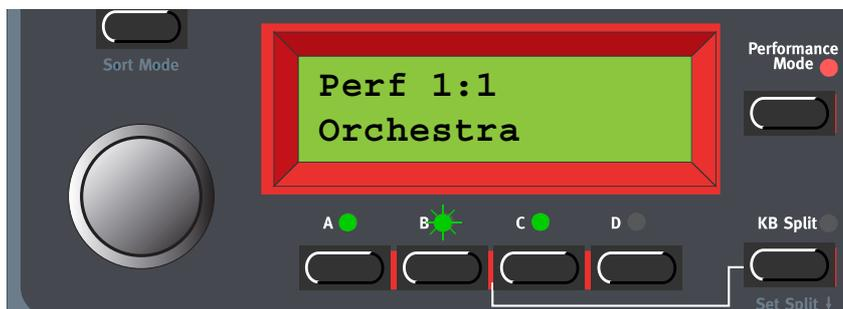
2. Haz doble clic en el botón de una **PARTE** que se esté usando en la Interpretación (la Parte A, en el ejemplo). Los LEDs de las demás Partes seleccionadas se apagarán. El **DISPLAY** mostrará la localización de memoria a la que pertenecía el Programa original de la Parte A y su nombre.
