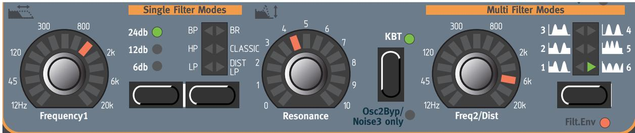
En los Modos Multi-Filtro, varios filtros se combinan para formar unos tipos de filtro más complejos. En estos modos utilizas todos los parámetros, incluyendo los mencionados para los Modos de Filtro Individual, para modelar el sonido.
