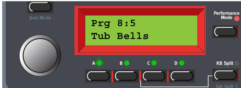
2. Selecciona un nuevo Programa para la Parte dejando pulsado el botón de la **PARTE A** y moviéndote con el **DIAL GIRATORIO**. Para alternar entre los Bancos de Programa, deja pulsado el botón de la **PARTE A** y usa los botones de navegación **ARRIBA / ABAJO**. Repite el procedimiento para las demás Partes.
