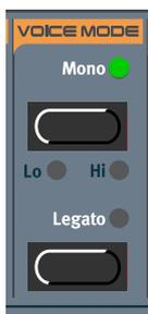
Presiona el botón **MONO** una vez para seleccionar el modo de operación Monofónica. El LED **MONO** se ilumina. En modo Mono sólo puedes tocar una nota a la vez, como en un tradicional sintetizador monofónico. Si tocas una tecla y luego una segunda tecla sin haber soltado la primera, sonará esta última tecla. Si sueltas la última tecla, la primera volverá a dispararse y empezará a sonar otra vez.
