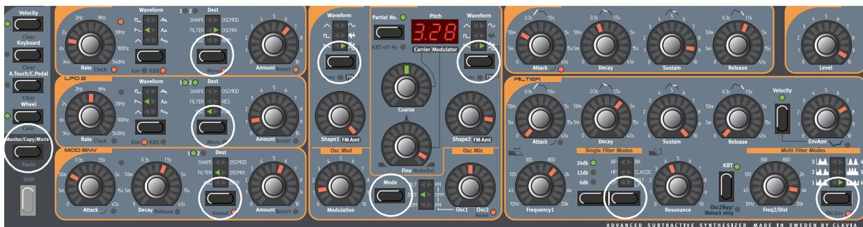
Manteniendo presionado el botón **MONITOR / COPY / MUTE** y pulsando cualquiera de los siguientes botones **SELECTORES**, la sección de parámetros elegida será desconectada de forma temporal: Asignación del LFO1 o 2, Asignación de la Envolvente de Modulación, Forma de Onda del Oscilador 1 o 2, Modo de la Modulación de los Osciladores y Tipo de Filtro.
