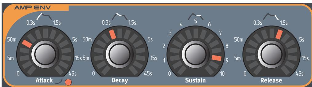
Un amplificador es a menudo utilizado en la etapa final del proceso por el que pasa la señal del amplificador, para controlar su volumen. Modulando el amplificador con una envoltente, al sonido puede dársele una “forma” básica. En realidad, la “forma del volumen” es uno de los más importantes factores a la hora de identificar el sonido. Configurando la envoltente de volumen apropiada puedes crear un sonido “suave”, “duro”, “percutido”, “estático”, etc.
