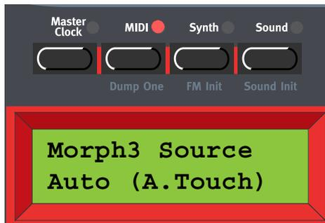
Aquí configuras cómo el grupo Morph 3 debe ser encaminado cuando uses un pedal de control. En modo “Auto” el grupo Morph 3 automáticamente cambia de Aftertouch a Pedal de Control nada más conectar un pedal de control al Nord Lead 3. Puedes además encaminar el grupo Morph 3 al Aftertouch o al Pedal de Control. Selecciona el modo con el **DIAL GIRATORIO**.
