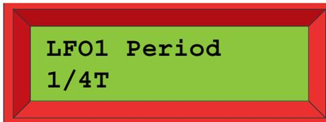
Gira el potenciómetro **RATE**, en modo de sincronía con el Reloj, para ajustar el periodo de la división o múltiplo.
