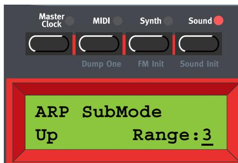
Presiona el botón de navegación **ABAJO** para entrar en el menú del Sub Arpegio. Aquí puedes seleccionar entre Subida (Up), Bajada (Down), Subida y Bajada (Up & Down), Aleatorio (Random) y Fijo (Still). Presiona el botón de navegación **DERECHA** para seleccionar el Alcance (Range) –el
