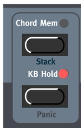
Presiona el botón **KB HOLD** para que cada nota o acorde que interpretes se mantenga hasta que pulses nuevas notas. Cuando interpretas una nueva nota o acorde, la nota o acorde previa se desvanecerá en el tiempo configurado para el Release de su Envolvente de Amplificación, y la nueva nota quedará mantenida.
