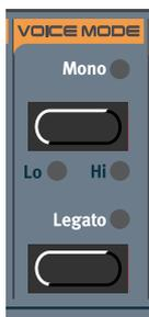
La sección de Modo de Voces consiste en dos partes, la parte Mono y la parte Legato. Las dos partes funcionan de forma separada la una de la otra, pero las combinaciones entre las dos crean interesantes efectos.
