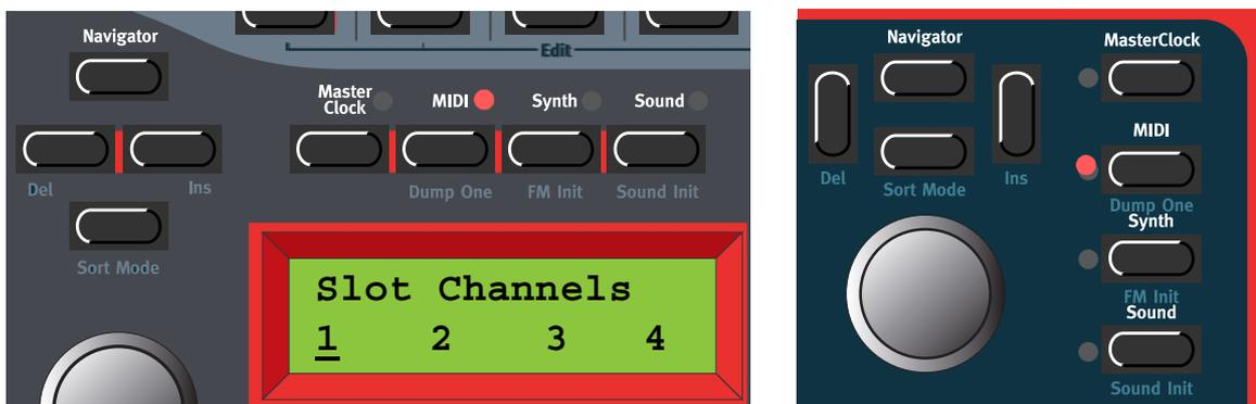
2. Desplázate con el **DIAL GIRATORIO** hasta seleccionar el canal MIDI 1 para la Parte A.
