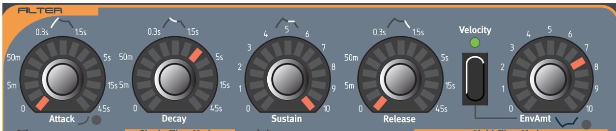
La Envolvente del Filtro es una típica envolvente ADSR. La Envolvente del Filtro controla el parámetro Frecuencia1 de frecuencia de corte, y también puede configurarse para controlar a la vez la Frecuencia1 y la Frecuencia2.
