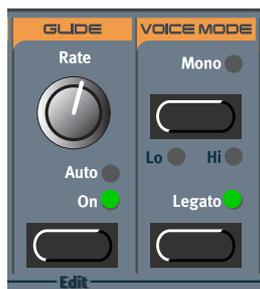
Una característica especial del Nord Lead 3 es la posibilidad de usar Legato Polifónico en conjunción con la función de Deslizamiento ¡para crear un deslizamiento polifónico! Activa la función de Deslizamiento presionando el botón **GLIDE** (no importa si el Deslizamiento está configurado en “On” o “Auto”, el efecto será el mismo en un caso como este en el que estás tocando en Legato). Después presiona el botón **LEGATO** para seleccionar el modo de operación Legato Polifónico.
