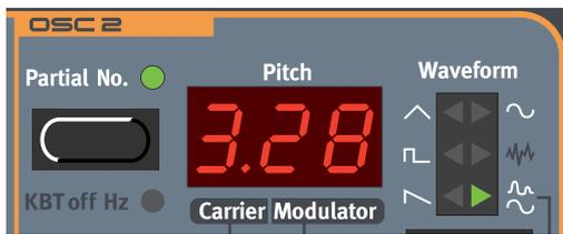
El **DISPLAY LED** de la Sección de los Osciladores se usa para mostrar información relacionada con la frecuencia o frecuencias del Oscilador 2. Esto puede ser mostrado de diversas formas:
