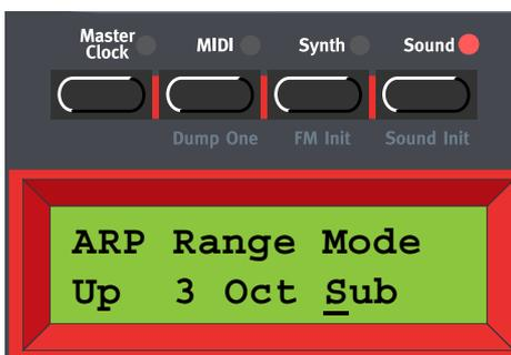
4. Presiona el botón de navegación **ABAJO** para entrar en el menú del Sub Arpeggio. Aquí puedes seleccionar entre Subida (Up), Bajada (Down), Subida y Bajada (Up & Down), Aleatorio (Random) and Fijo (Still). Presiona el botón de navegación **DERECHA** para seleccionar el Alcance (Range) –el cursor se moverá a la derecha en el **DISPLAY**. Selecciona el Alcance (1-8 teclas / notas) girando el **DIAL GIRATORIO**.
