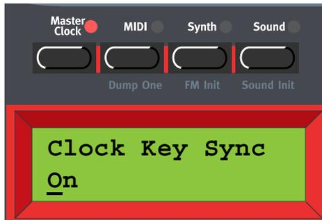
Activa o desactiva la Sincronía del Reloj al Teclado (Clock Key Sync) girando el **DIAL GIRATORIO**. Cuando la Sincronía del Reloj al Teclado está activada, nada más presionar una/s nueva/s tecla/s después de haber soltado la/s previa/s el Reloj Maestro se reinicia de forma inmediata. Cuando la Sincronía del Reloj al Teclado está desconectada, nada más presionar una nueva tecla el arpegio continuará en la siguiente señal del Reloj Maestro. Pulsa el botón **MASTER CLOCK** para salir.
