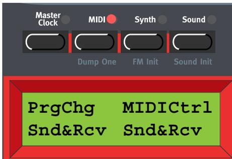
Aquí configuras cómo se va a tratar a los mensajes de Cambio de Programa y de Controlador MIDI. Selecciona PrgChg o MIDICtrl con los botones de navegación **IZQUIERDA / DERECHA**. Selecciona el modo para la función seleccionada con el **DIAL GIRATORIO**.
