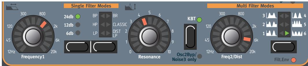
Si giras **FREQUENCY1**, el Display mostrará el valor de Frecuencia1 y su relación con Frecuencia2. En el ejemplo, Frecuencia1 es 1/6.349 de Frecuencia2
