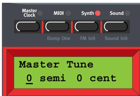
Aquí cambias la configuración de la Afinación Maestra global del Nord Lead 3. Cambia la afinación maestra, en semitonos, con el **DIAL GIRATORIO**. “0” es la afinación normal a 440Hz. El intervalo es de +/-6 semitonos, en pasos de 1 semitono. Presiona el botón de navegación **DERECHA** para cambiar la Afinación Maestra, en centésimas, con el **DIAL GIRATORIO**. El intervalo es de +/-1 semitono, en pasos de 1 centésima de un semitono.
