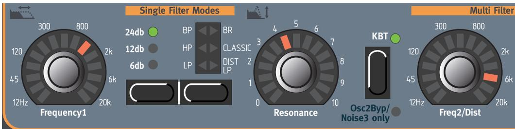
En los Modos de Filtro Individual usas un único filtro para el que puedes controlar la frecuencia de corte, la pendiente, el modo de filtro, la resonancia y el Seguimiento del Teclado.
