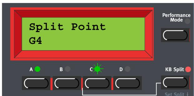
2. Mientras pulsas los botones **SHIFT** y **KEYBOARD SPLIT**, presiona la nota más baja para la sección superior del teclado. El **DISPLAY** te muestra la nota que has presionado.
