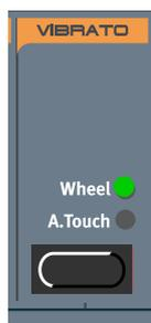
Usar la función de Vibrato es una manera sencilla de añadirle vibrato a tu sonido sin tener que encaminar un LFO al tono de un Oscilador. El Vibrato es global para la Parte, es decir, afecta a todas las voces por igual. El Vibrato puede considerarse un LFO individual, separado del resto de LFOs del Nord Lead 3.
