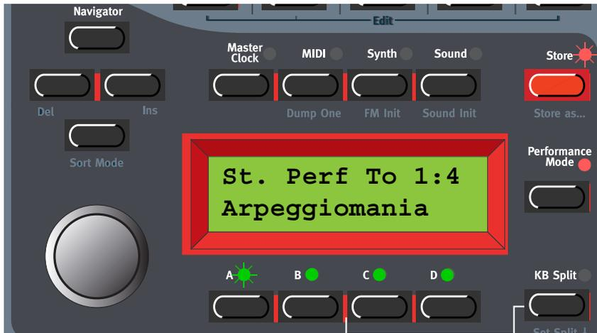
2. Selecciona una localización de memoria girando el **DIAL GIRATORIO**. Alterna entre los Bancos 1-2 pulsando los botones de navegación **ARRIBA / ABAJO**. Mientras te mueves por las localizaciones de memoria, puedes tocar y escuchar las Interpretaciones que muestra el **DISPLAY**. Esto te previene de sobrescribir una Interpretación que querías conservar.
